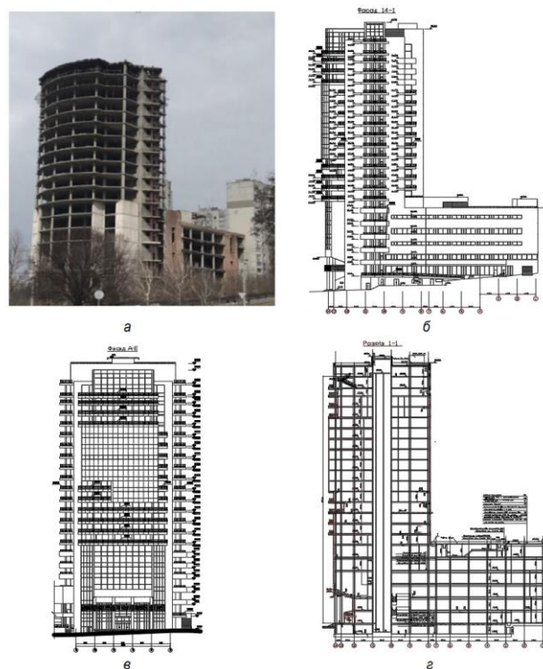
Рис.1 – Комерційно-адміністративний об'єкт: а) недобудова; б) креслення фасаду 14-1; в) креслення фасаду А-Е; г) розріз 1-1
